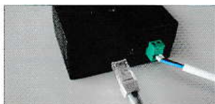
6. Vložte "kalibrační klíč" do zásuvky určené pro kabel ovládacího spínače.
