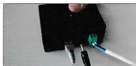
7. Připojte napájecí zdroj do řídicí jednotky.
