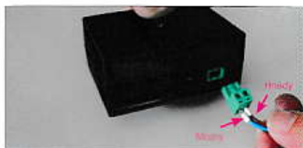
5. Připojte kabel k řídicí jednotce.
