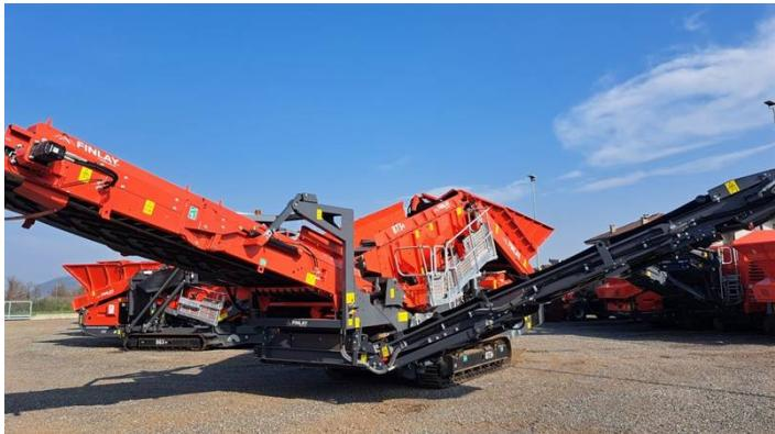
**Marca: FINLAY****Anno: 2023****Ore: 7****Motore Stage V Deutz TCD 3.6L4 - 134 HP****Peso 26.160 Kg****Capacità della tramoggia: 7 m<sup>3</sup>****Superficie di vagliatura complessiva: 10,95 m<sup>2</sup>****Piano superiore e inferiore: 3.66 m x 1.5 m****Tines 55 mm****Rete 20 mm****MATERIALI FINI**
