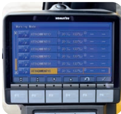
Komatsu Integrated Attachment Control (KIAC) para hasta 15 configuraciones de implementos para ajustar el caudal aceite y presión (opcional)
