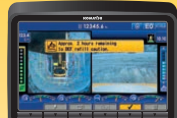
Pantalla de regeneración del dispositivo de emisiones para KDPF
