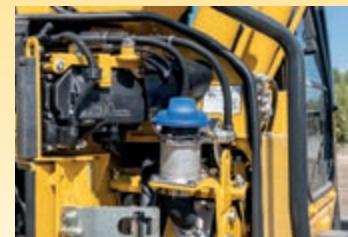
Para facilitar el acceso, el depósito AdBlue® se encuentra instalado en la escalera delantera.
