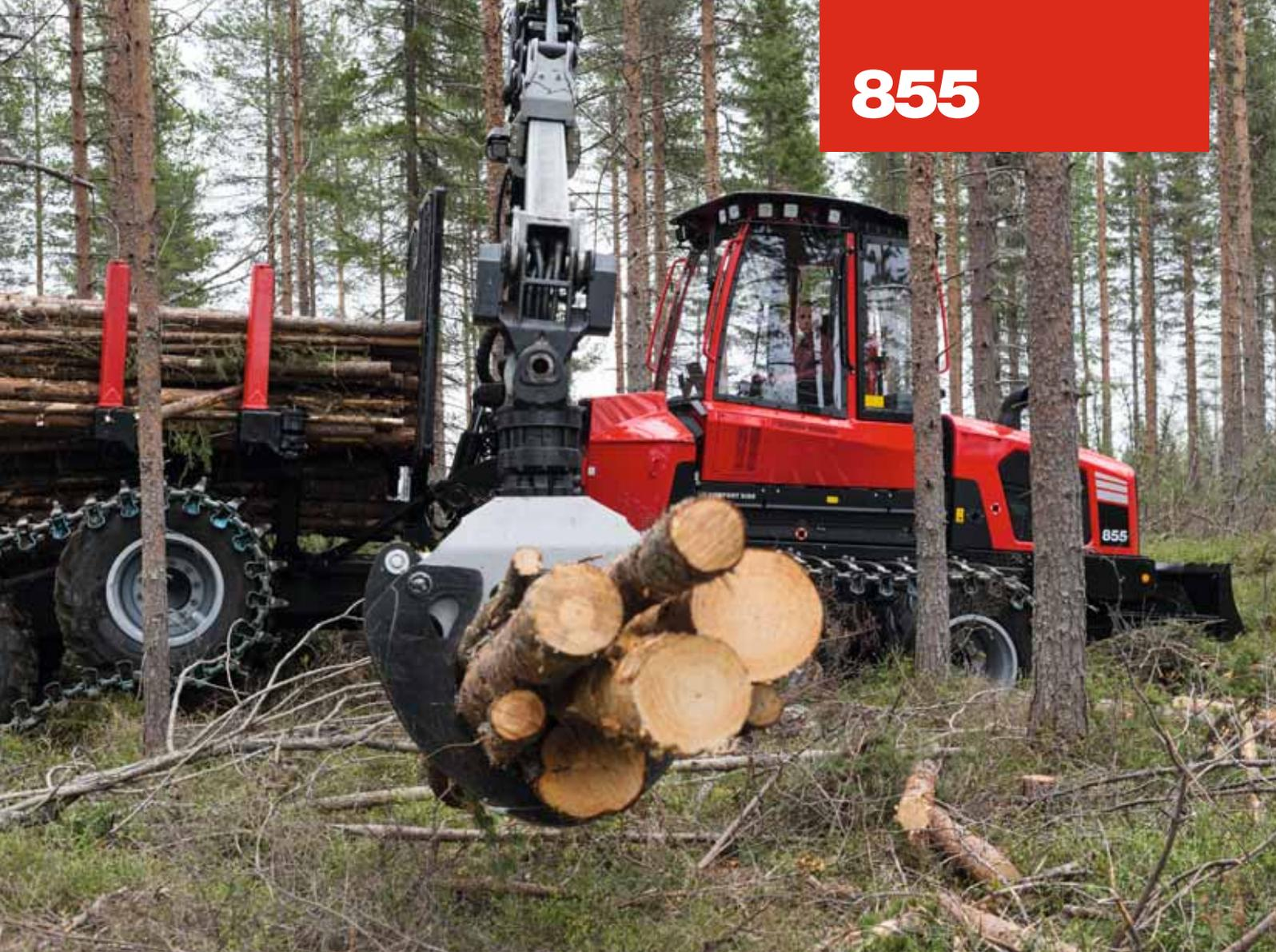
Nicht weniger wichtig für ein effektives Vorliefern ist der leistungsstarke, schnelle und flexible Kran mit großer Reichweite. Ein weiteres Leistungsmerkmal des Komatsu 855. Der Kran zeichnet sich durch eine hohe Nettohubkraft, die betriebssichere Säulen- und Schlauchführungslösung sowie den Combi-Wipparm mit großer Reichweite und geschützter Schlauchführung aus. Optional steht ein kompaktes ProTec Gelenk zur Ladungserfassung zur Verfügung.
