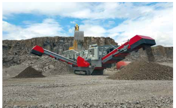
GIPOREC R131 FDR mit Seitenaustragsband / with side discharge conveyor / avec tapis de décharge latéral
