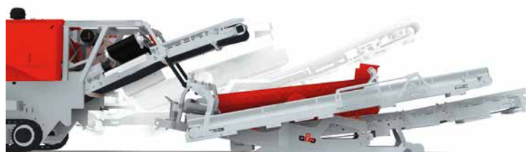
Einfaches an- und abkoppeln der Siebeinheit / Easy coupling and uncoupling of the screening unit / Couplage et découplage aisé de l'unité de criblage
