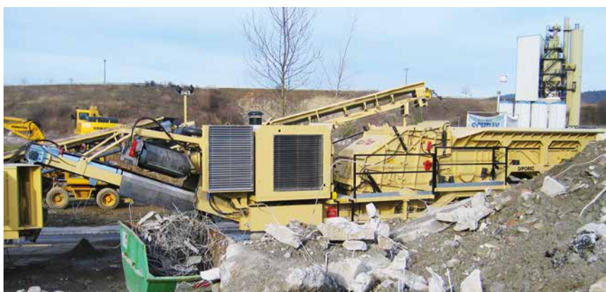
R130 FDR Einsatz im stark armierten Betonabbruch / for heavily reinforced concrete / Utilisation pour les déchets de béton fortement armé
