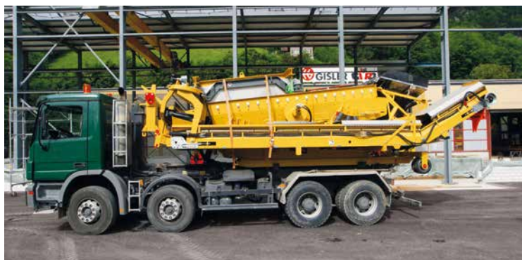
GIGA Siebeinheit hackenliftmobil / GIGA Screening unit hook-lift mobile / GIGA Unité de criblage, mobile sur châssis berce
