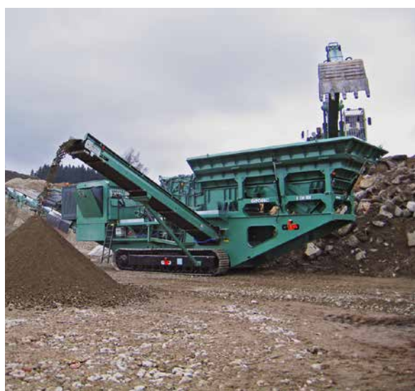
R130 FDR mit Vorabsiebung und Seitenausfrag / with pre-screening and side discharge / avec précriblage et décharge latérale
