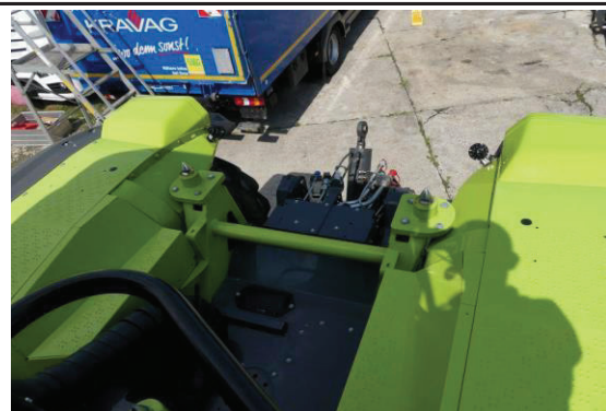
Ansicht Aufnahme drehbare Kabine
