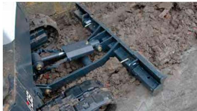
Unterwagen und Planierschild mit Spurbreitenverstellung sind serienmäßig am Start. Die Schildverbreiterungen müssen nicht demontiert und neu montiert werden.
