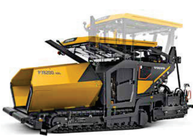
Techo acristalado electro-hidráulico
