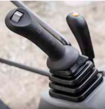
Steuerung über hydraulischen Schalter
