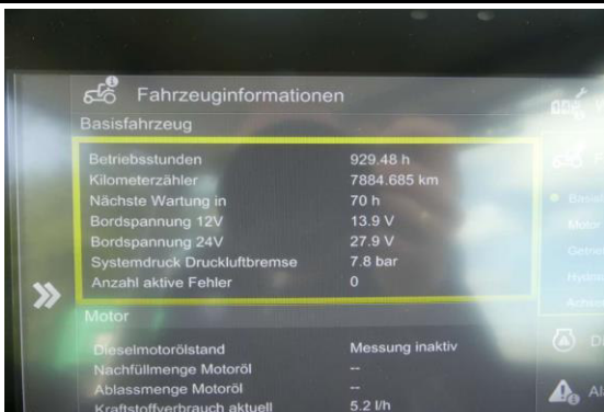
Ansicht Instrumentendisplay Betriebsdaten
