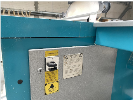
Tabliczka znamionowa z danymi elektrycznymi i zakresem tarcz, pulpit z wyborem prędkości 2800/4000/5500 obr./min oraz wyłącznik główny z tabliczkami ostrzegawczymi.
