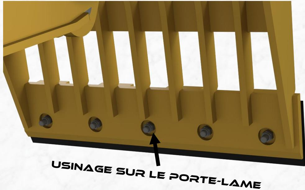
La partie usinée sur le porte-lame permet à l'écrou d'être complètement intégré et donc protégé des chocs éventuels lors des phases de travail. Cela facilite également le remplacement des lames.
