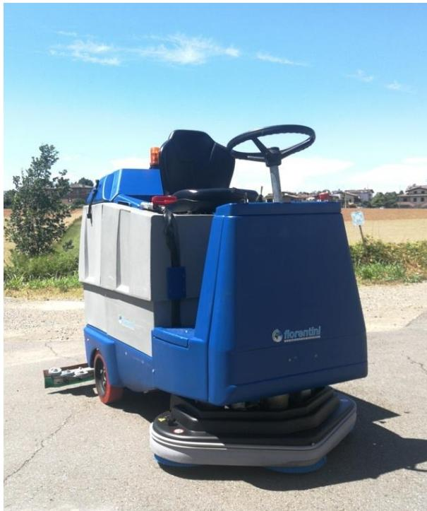
I38 è una robusta lavasciuga pavimenti in grado di, lavare ed asciugare il pavimento in un unico passaggio.
