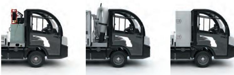
Konfigurationen mit Kipper oder Müllkipper ermöglichen eine schnelle Anpassung des Fahrzeugs durch die Kombination mit Hochdruckreiniger, Laubsammler oder einer Aufbewahrungsbox.
