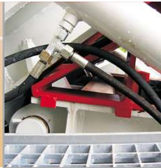
Sicherung des Prallmühlenoberteils Locking device of the upper part of the impact crusher
