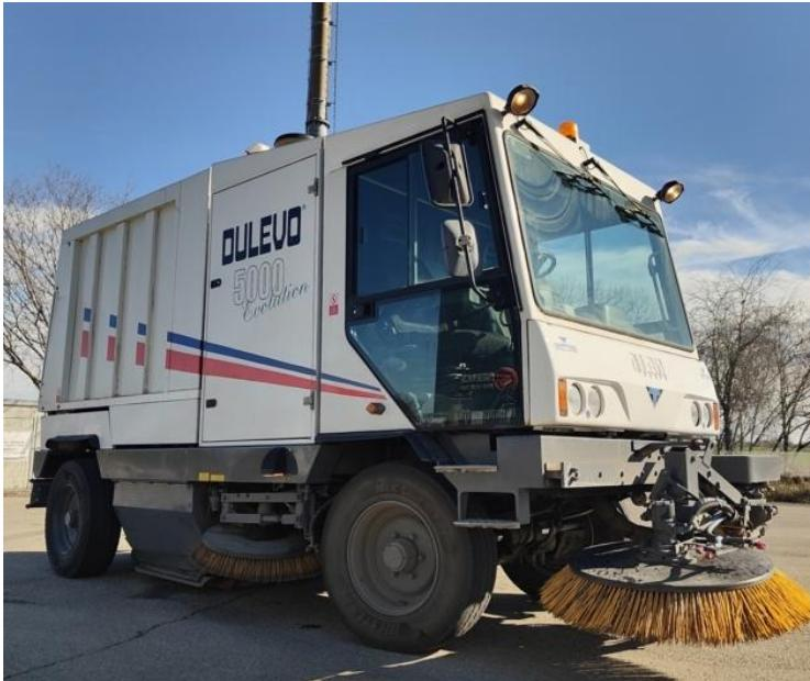
DULEVO 5000 è una robusta spazzatrice stradale targata, dotata del sistema "Meccanico-Aspirante-Filtrante". Dotata di targa gialla – Patente B.
