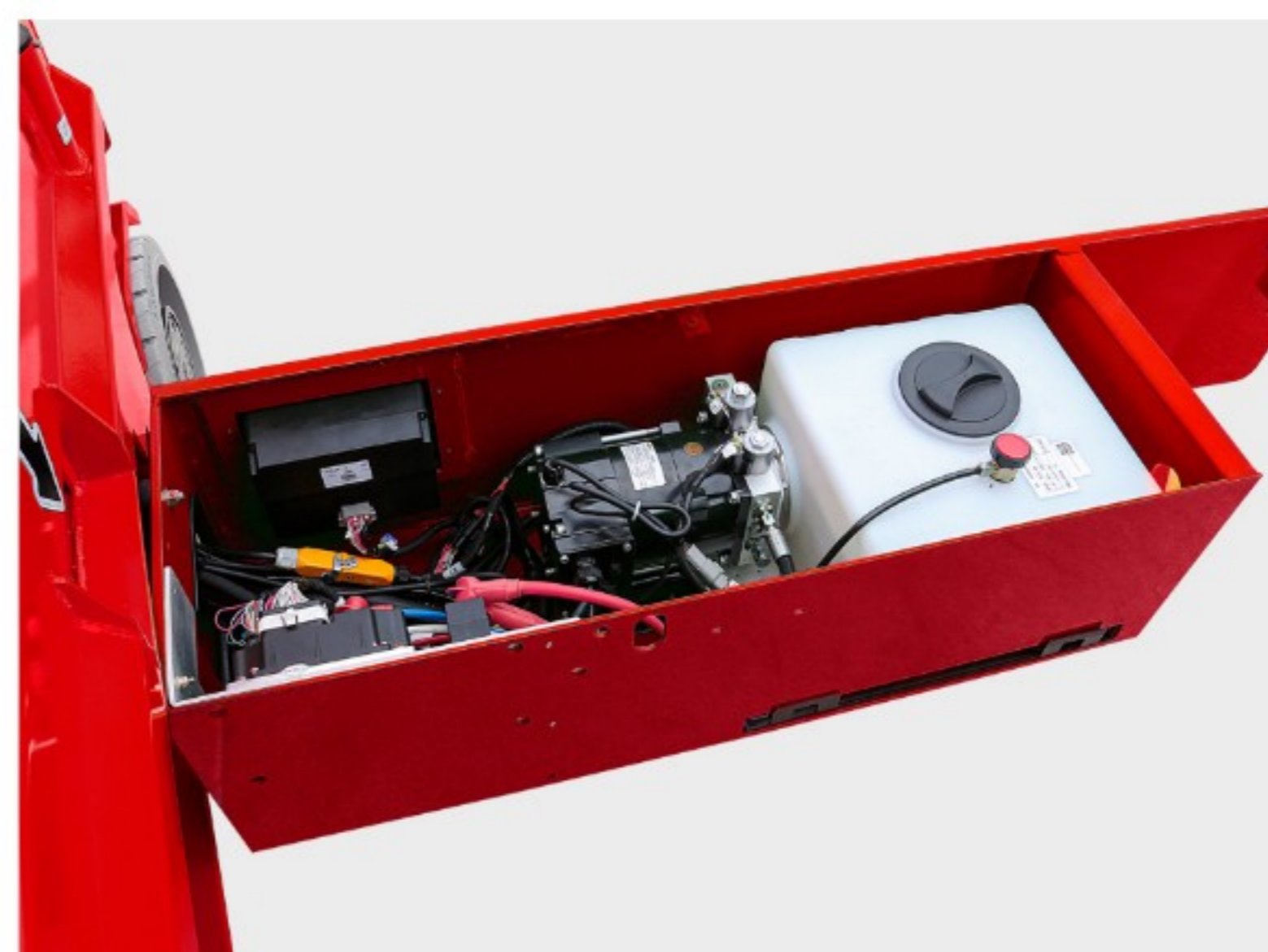
Pompinstallatie met hoog rendement
