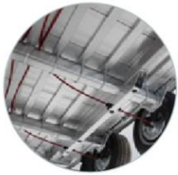
IJzersterke vloerondersteuning door vele kokerprofielen
