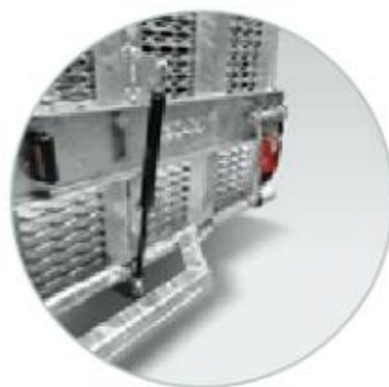
Accessoire: Gasveer voor klephoogte 150 cm
