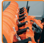
Überfahrtsicherung durch vorgespannte elastische Schwinglenker
