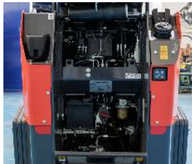
Hinterer Zugang zu Batterie und Pumpe.
