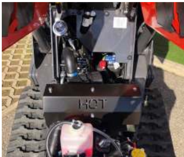
Vorderer Zugang zu Motor, Luft- und Kraftstofffilter.
