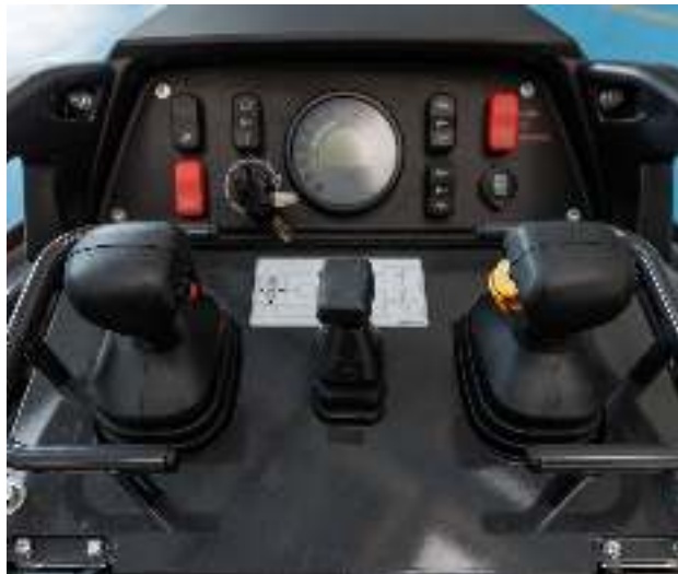
Steuerkonsole mit vorgesteuerten hydraulischen Joysticks.
